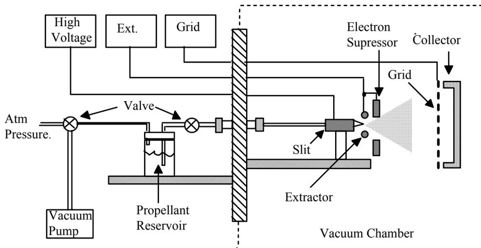
Fig. 7. Colloid microthruster test apparatus.
