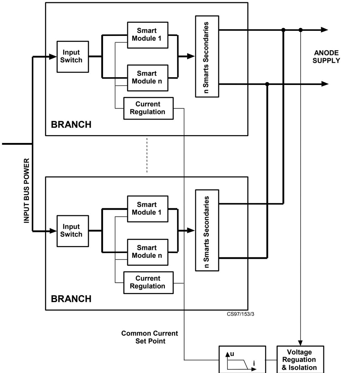
**Figure 5 : HPPU : Branches in parallel**
