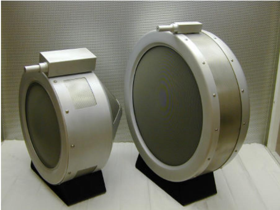
Figure 14 - DS1 thruster and 40 cm engine.
