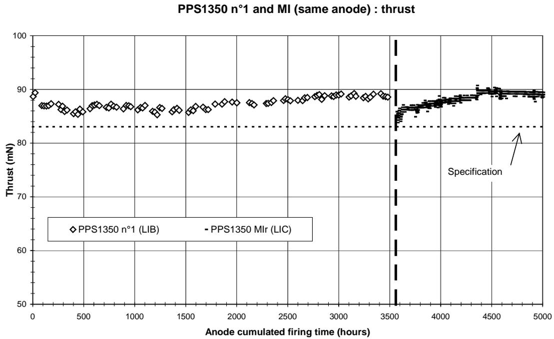
Fig. 5 : PPS 1350-G type Chamber and anode : Thrust
