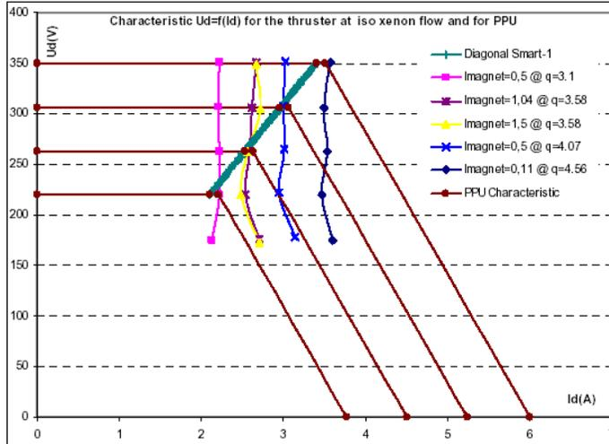
Figure 9. SMART-1 : PPS-1350 Operating points<sup>19</sup>
